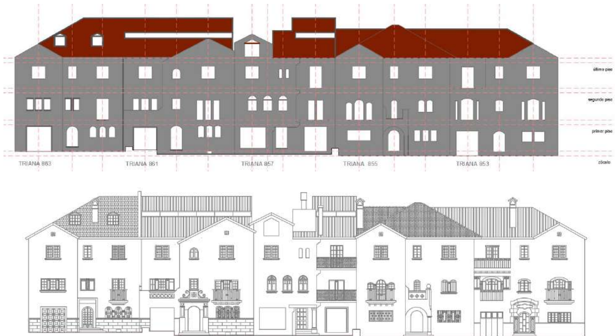
Figura 55 Elevaciones y análisis morfológico de la edificación en la ZCH Conjunto calle Triana N° 853 a N° 863. Fuente: Elaboración propia.
